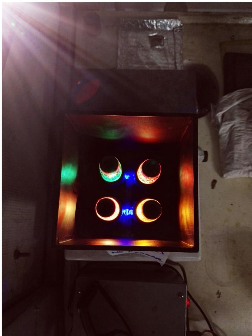
De la oscuridad a la luz... reacciones fotoquímicas con luz visible (LED Azul).
